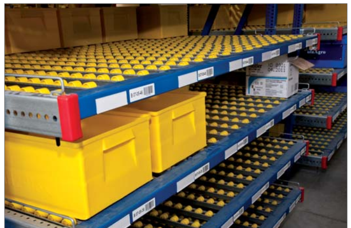
Átfutó görgősoros polcrendszer a kommisszó raktárban
